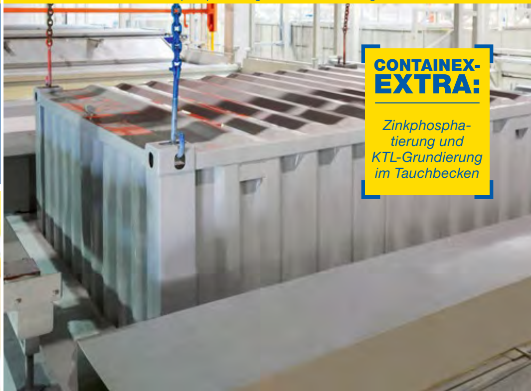
Zinkphosphatierung und KTL-Grundierung
